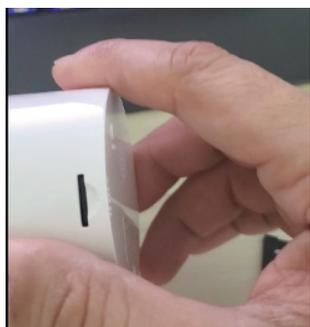
7. Mantén presionado el botón de Reposición . Utiliza el cable USB suministrado por el usuario para conectar la cámara a la computadora y luego enciéndela.
