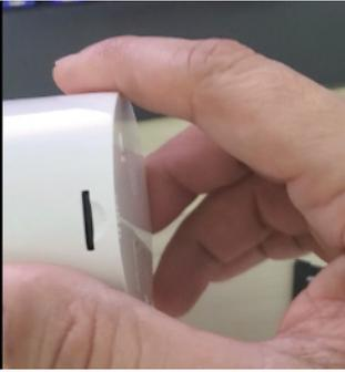
9. Mantén presionado el botón de Reposición . Utiliza el cable USB suministrado por el usuario para conectar la cámara a la computadora y luego encenderla
