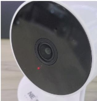
10. Desconecta la cámara Wi-Fi de la fuente de alimentación con el fin de reiniciar el sistema. Retira la tarjeta microSD de la cámara.
