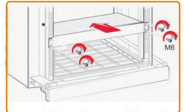
b) Para instalar el switch en el bastidor o gabinete, atornille las orejas de montaje a las bridas de montaje verticales frontales usando tornillos M6.
